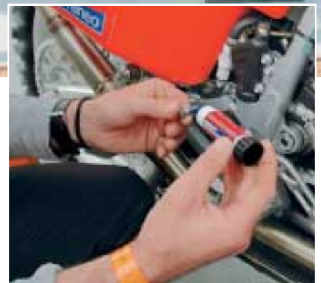
Wenn nichts mehr hält: Aufgrund starker Vibrationen und der Dauerbelastung im Rennbetrieb werden viele Schraubverbindungen vorab mit Schraubensicherungen versehen (Bild rechts). Bilder: Blenk, A.S.O, Henkel
