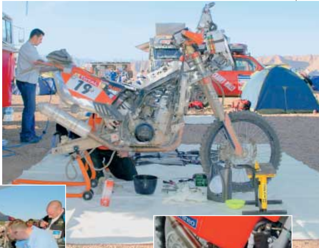
Wenn nichts mehr hält: Aufgrund starker Vibrationen und der Dauerbelastung im Rennbetrieb werden viele Schraubverbindungen vorab mit Schraubensicherungen versehen (Bild rechts). Bilder: Blenk, A.S.O, Henkel
