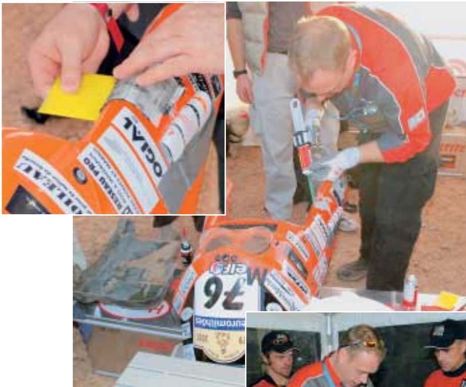
Schnelle Hilfe nach dem Crash: Die gebrochene Frontmaske der KTM 660 Rallye von Frederic Lapan (FRA, Nr. 076) konnte mit Hilfe eines Zweikomponentenklebers und einem Verstärkungsvlies dauerhaft repariert werden. Die defekte Verkleidung von Janis Vinters (LET, Nr. 023) wartete bereits. Beide Piloten erreichten später als 26. beziehungsweise als 6. das Ziel in Dakar. Bilder: Blenk
