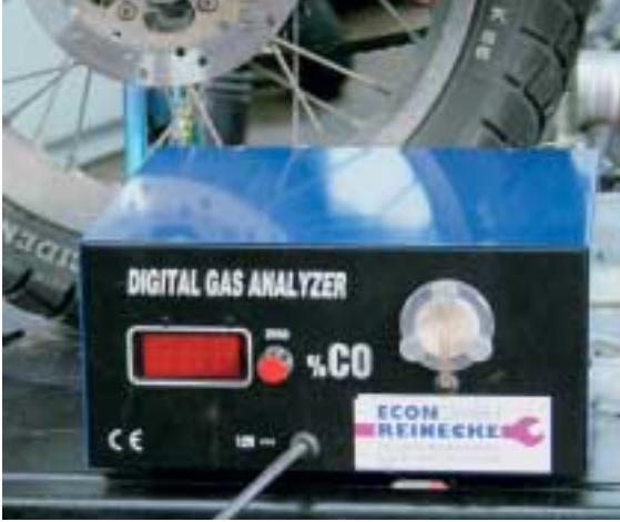
CO-Messgerät: Das am Auspuff neben anderen schädlichen Gasen austretende geruchlose Kohlenmonoxid ist in erhöhter Konzentration hochentzündlich und giftig. Bild: Heckmann
