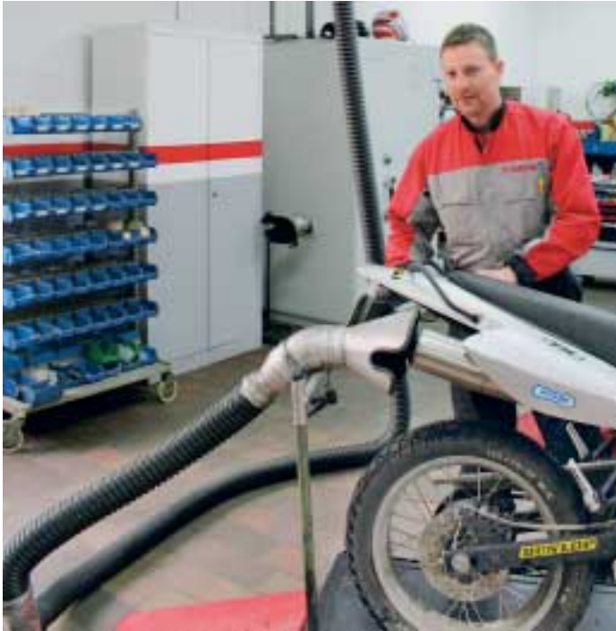
Status quo: Eine Abgas-Absauganlage ist aufgrund der Vorschriften unter anderem aus dem Arbeitsschutzgesetz auch für Betriebe, die Motorräder in der Werkstatt reparieren, Stand der Technik. Bild: Heckmann
