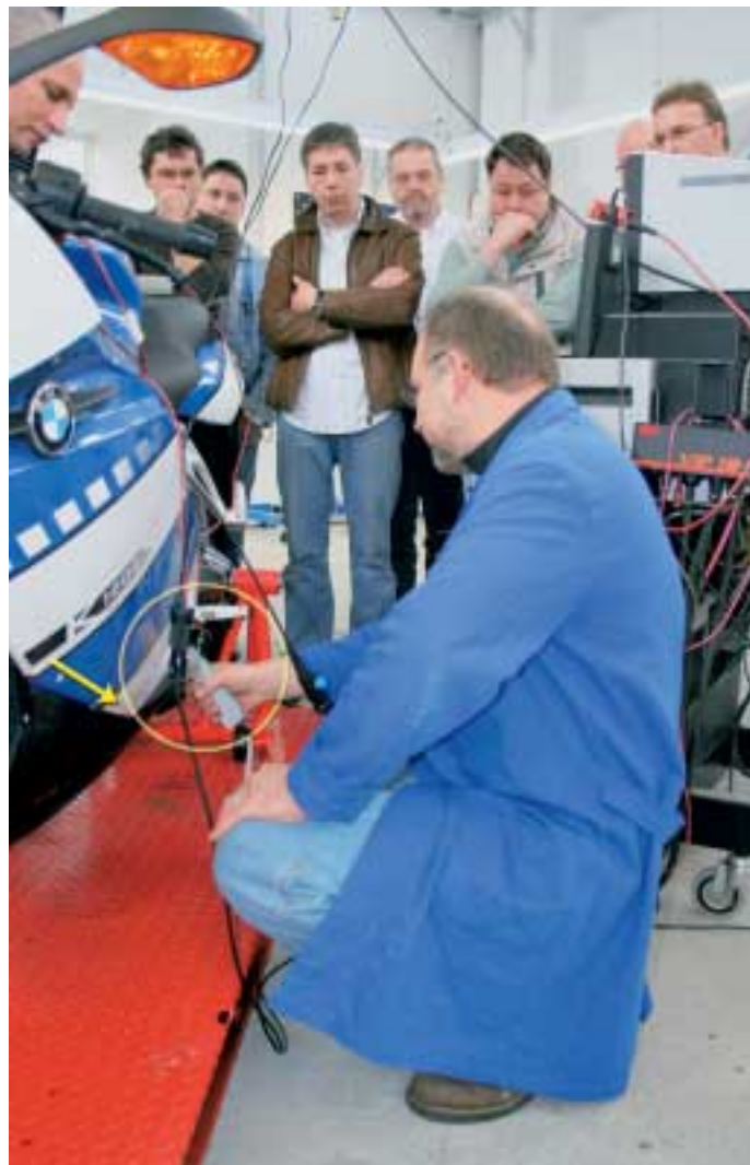
Heißes Eisen: Prüfung der Motortemperatur mittels IR-Pistole (Pfeil). Bild: Heckmann
