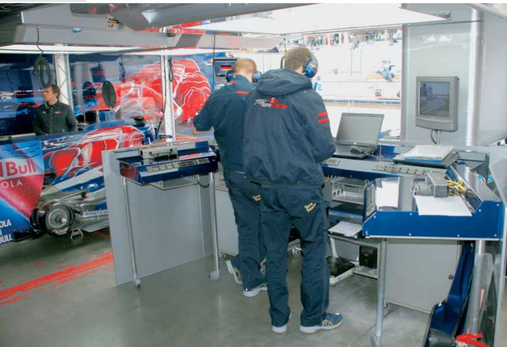
Schaltzentrale: In der Mitte der Box werden unter anderem Fahrzeugdaten aufgenommen, gespeichert und ausgewertet. Bild: Blenk
