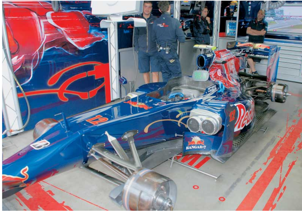
„Ready to race“: Der „STR4“, angetrieben von einem Ferrari V8, Typ-056, (2,4 l Hubraum und maximal 18.000/min) kurz vor dem nächsten Trainingslauf. Bild: Blenk
